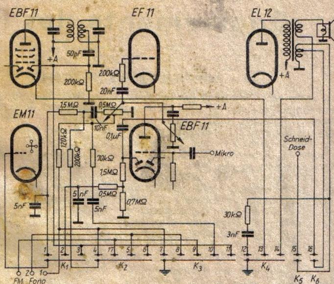
Prinzipische Schaltung und Schalterdiagramm des Betriebsarten-Umschalters
