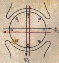
Abb. 3. Magnetische Flüsse in der Reihenschlußmaschine
