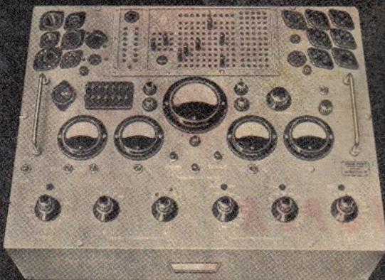
Röhrenprüf-, Meß- und Regeneriergerät
