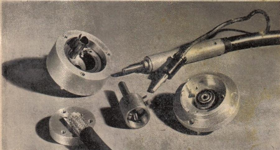
Zerlegter HF-Spannungsteiler des Prüfsenders und Tastkopf mit künstlicher Antenne
