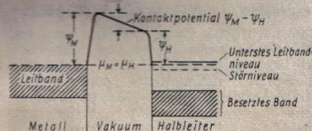
Abb. 3. Potentialverlauf zwischen einem Metall und einem Halbleiter, wenn die Grenzenergieniveaus  $\mu_M$  und  $\mu_H$  gleich hoch liegen. Bei einem Überschulhalbleiter liegt  $\mu$  zwischen dem teilweise besetzten angenommenen Störniveau und dem teilweise besetzten untersten Leitbandniveau
