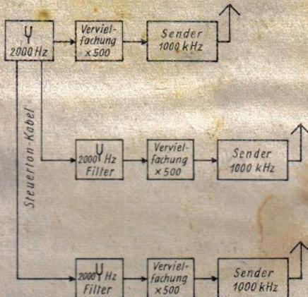
Abb. 3. Gleichwellensender mit zentraler Stimmgabelsteuerung
