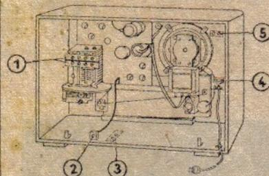
① Anschlußeiste für Tonabnehmer und UKW-Umschaltkasten, ② Antennensteckbuchse, ③ Befestigung des Sperrkreises RFZ 47, ④ Sicherung, ⑤ Anschlußeiste für UKW-Zusatzgerät
