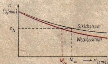
Abb. 4. Abhängigkeit des Drehmomentes von der Drehzahl
