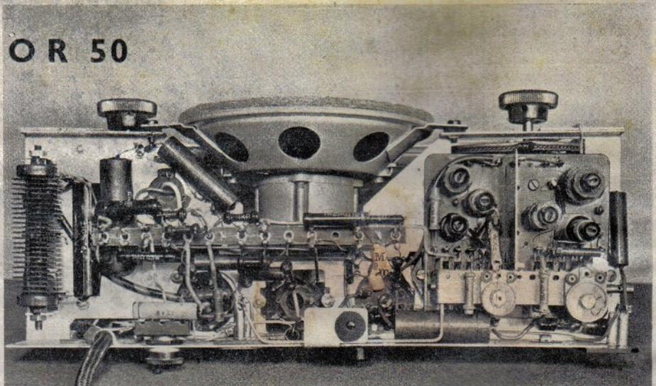
Chassisaufnahme von unten. Auf diesem Bild ist besonders gut die übersichtliche Leitungsführung und der große Lautsprecher zu erkennen
