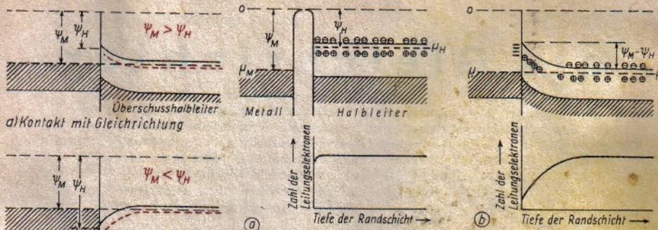
Abb. 4. Schaubild der Energieniveaus bei der Herstellung eines Kontaktes zwischen Metall und einem Überschubhalbleiter. a) Zustand vor Berührung. b) Zustand nach Berührung und Herstellung von Gleichgewicht in der Elektronenverteilung. Unten: Entsprechende Elektronendichte im Randgebiet des Halbleiters
