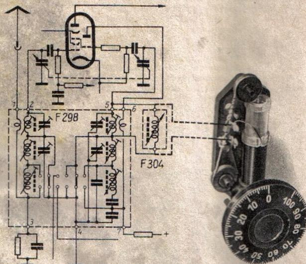
Banddehner Görlner F 304 in Verbindung mit dem Superspulensatz F 298
