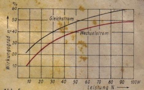
Abb. 5. Mittlere Wirkungsgrade des Universal-Kleinmotors
