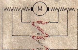
Abb. 2. Umschaltbarer Universalmotor
